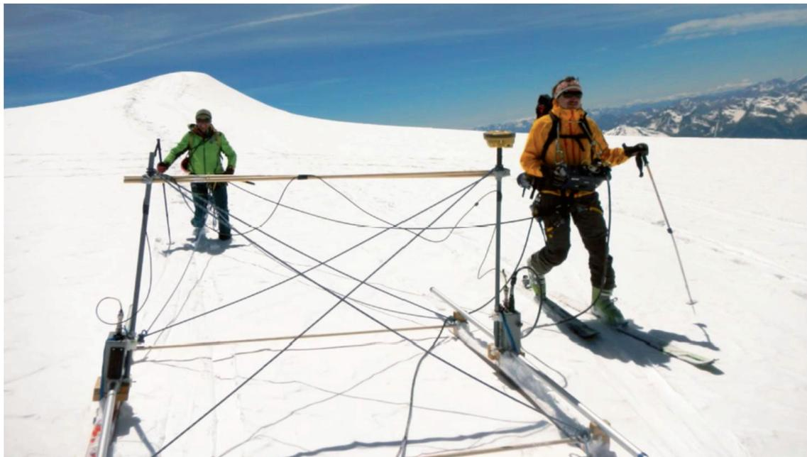
Abbildung 9: Das GPR-Messgerät in der verwendeten Konfiguration am Oberen Ortlerferner. Foto: Waldhuber-Stockner.
