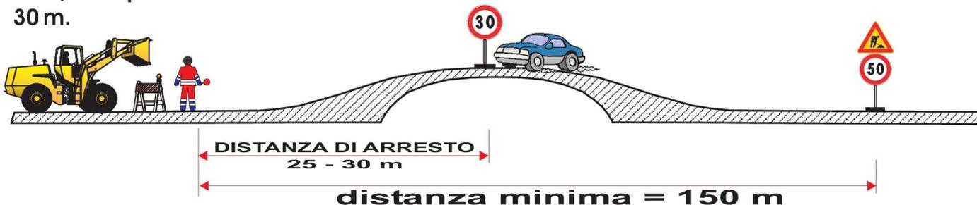
**Attenzione:** lo schema (vedi fig. sopra) è adeguato solo se si esclude la formazione di colonna nel tratto compreso fra la sommità del dosso o curva (scarsa visibilità) ed il cantiere.
