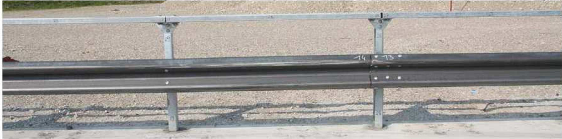
↑ Deuxième choc (lisses n°13 et 14) / Second impact (W-beams nrs. 13 and 14) / Secondo urto (nastri n°13 e 14)
