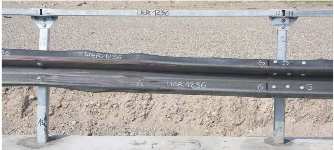
↑ Point de choc (lisse n°6) / Impact point (W-beam nr. 6) / Punto d'urto (nastro n°6)
