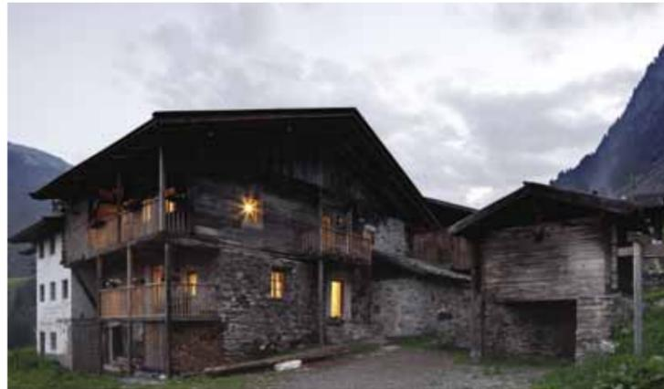
Der Krustnerhof vermittelt noch den Charakter eines mittelalterlichen Hofes mit typischen Elementen: ein Holzblockbau kragt über den steingemauerten Unterbau aus und wird von einem einfachen Satteldach gedeckt. Die Balkone wurden erst später hinzugefügt.
