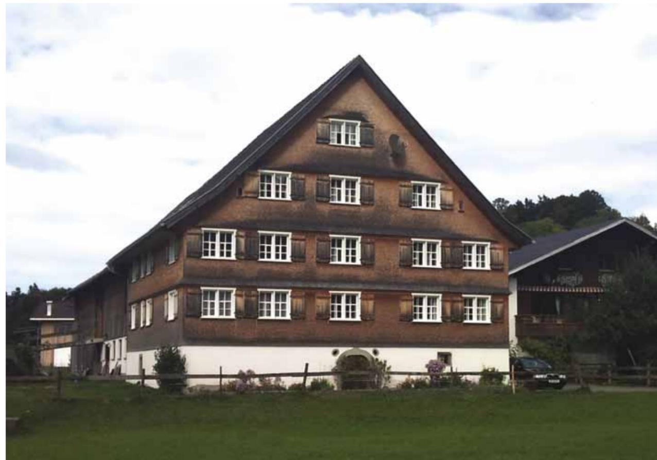
„Schieberfenster“ sind charakteristisch für den Bregenzerwald. Sie wurden originalgetreu rekonstruiert. Das flache Relief der Fassade erlaubte unter den neuen Schindeln eine dünne Dämmschicht, ohne dass der Gesamteindruck beeinträchtigt wird.
