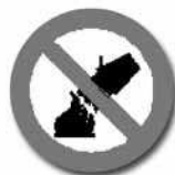
Mit Wasser löschen verboten
