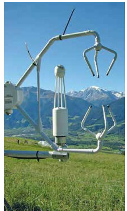
Strumento per la misurazione dell'anidride carbonica
