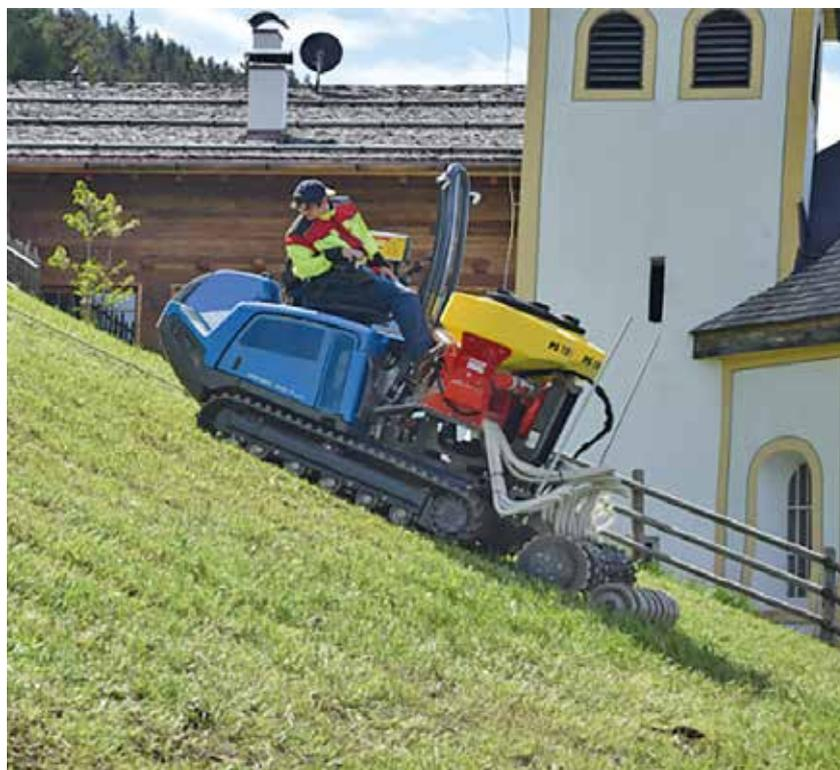
Fig.1. Schema del prototipo di seminatrice per sod-seeding realizzato e visualizzazione della macchina in fase di lavoro su pendenza del 60% (in collab. con Geier srl, Marlengo-BZ)
