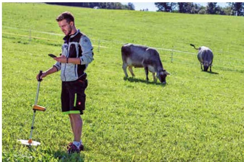
Fig. 1: Misura dell'altezza dell'erba mediante erbometro
