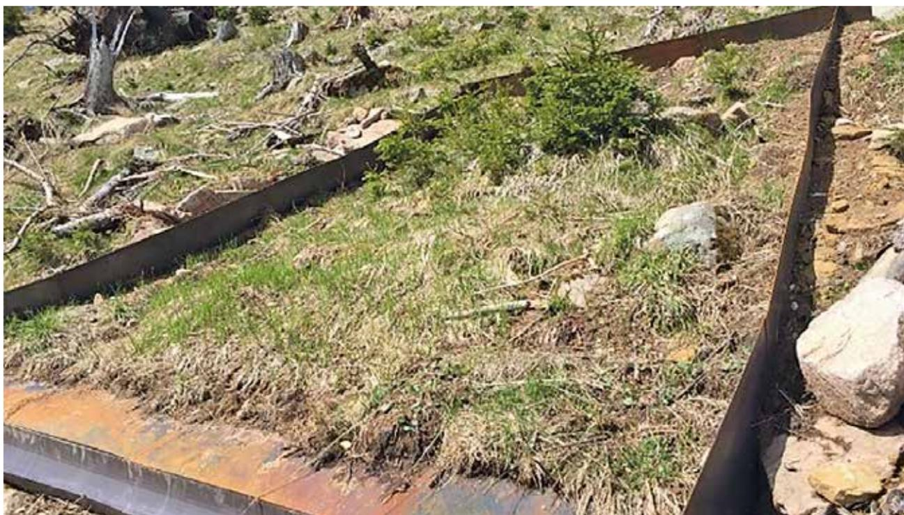
Fig. 1. Installazioni delle parcelle sperimentali per la misura del ruscellamento e del sedimento prodotto di erosione nei pressi del Passo Lavazè nell'ambito del progetto MoniVa.
