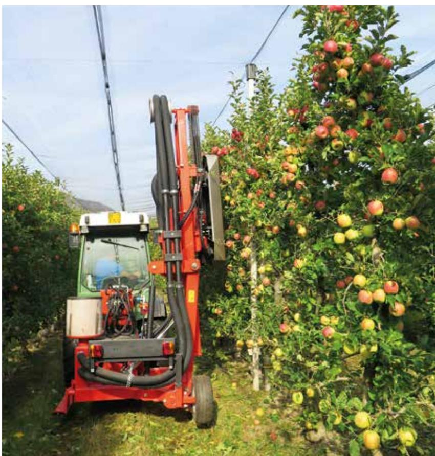
Fig. 2: Macchinario per la sfogliatura meccanica in azione
