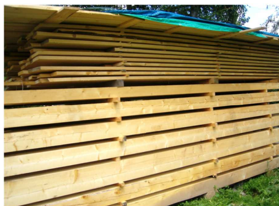
Foto 3 Copertura della catasta
